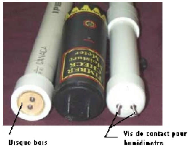
Figure 2-Détails des deux extrémités des sondes et de l'humidimètre
