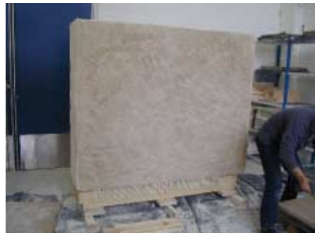
Figure 21 Mur paille avec enduits
