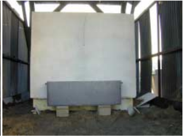
Figure 36 - Mise en place du réservoir d'heptane
