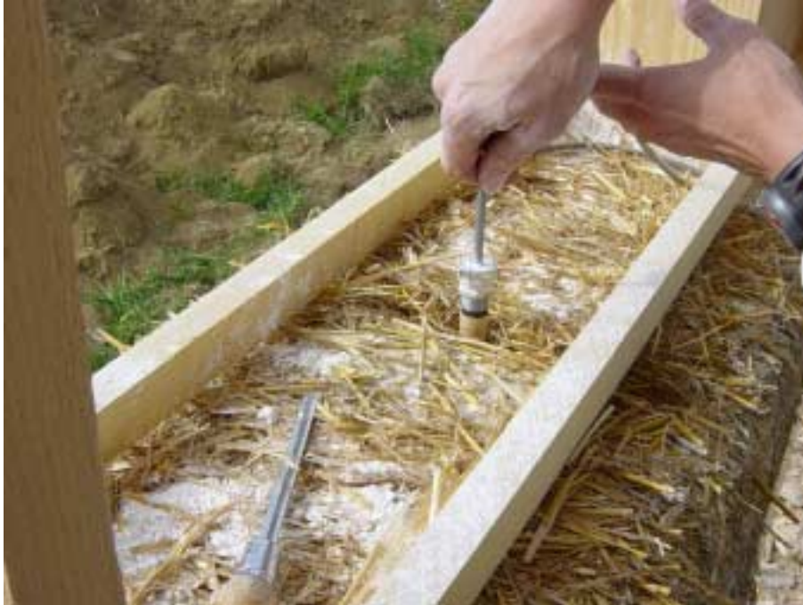
Figure 52 - Les trois sorties de sondes par section
