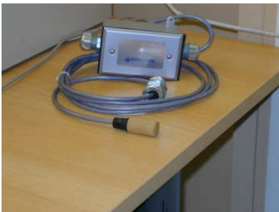
Figure 49 – Sonde et convertisseur GENERAL EASTERN RH T2-IR
