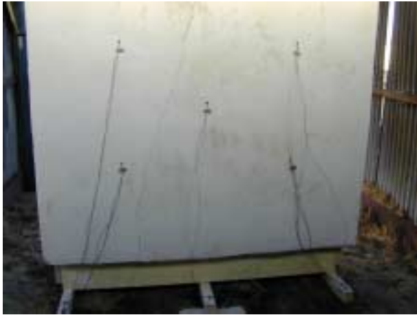
Figure 35 - Maquette de mur équipée de thermocouples
